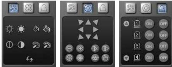
Il primo pulsante **"COLOR"** permette di modificare luminosità, colore e contrasto di ogni segnale delle telecamere. ATTENZIONE le modifiche effettuate tramite il RAS variano le immagini che vengono registrate sul DVR, si consiglia quindi di utilizzare questo strumento di videoritocco con molta attenzione. Per ripristinare i valori di default cliccare sul simbolo con le due frecce.
